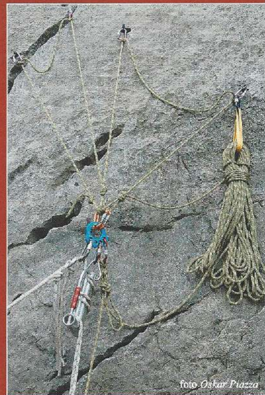
1. Allestimento ancoraggio fisso-soccorso con piastra multi-attacco e Freno Tuba con corde statiche.
